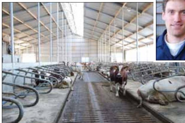
Hell und hoch: Die Firsthöhe des 2010 erbauten Stalles beträgt 11 m, an den offenen Seitenwänden sind Curtains angebracht. Der Stall bietet Platz für 106 Kühe, bislang hält Gerben Nijzink hier 72 Kühe. Fotos: Quinckhardt
